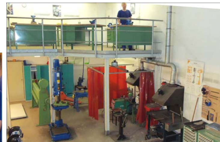
Die Metallwerkstatt mit Blechbearbeitung, Schmiede und Schweißkabine. Auf der Empore die Werkbänke.
